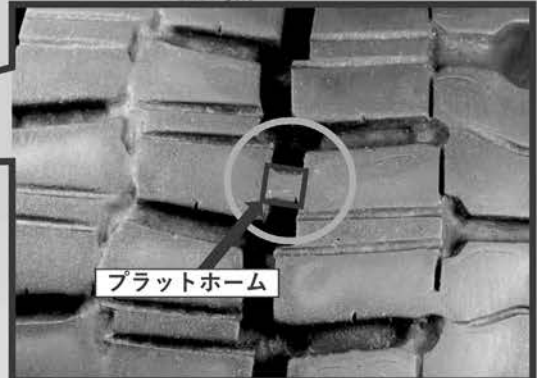
残り溝深さが「プラットホーム」に達している状態。冬用タイヤとして使用できません。
